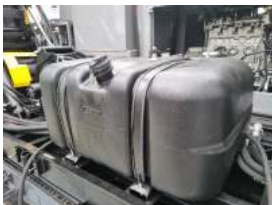
RESERVATÓRIO DE ÓLEO DIESEL
